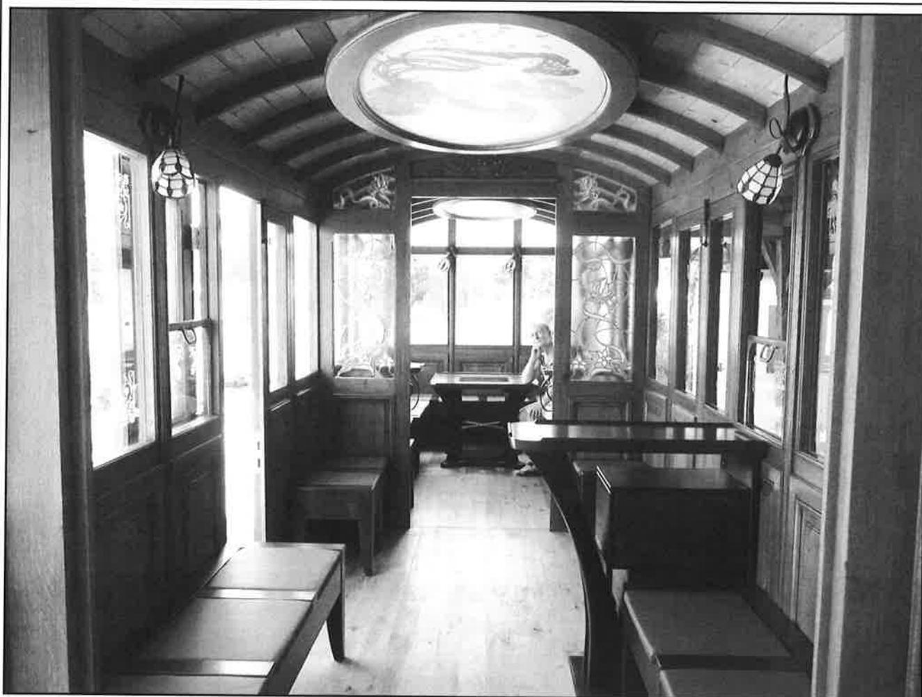
**Vue intérieure de la voiture dite "Orient-Express". Un compartiment à une extrémité avec bancs et table, séparations réalisées en bois avec panneaux en vitraux, reproduction "Modern-Style". Les vitrages de la voiture sont décorés avec des motifs gravés. Lampes en verres opalescents découpés, assemblés au plomb.**
