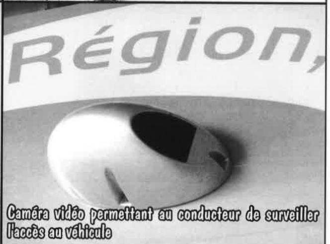
Caméra vidéo permettant au conducteur de surveiller l'accès au véhicule
